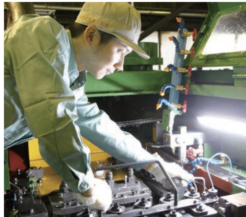
冷間ホーマーのセットアップ作業
