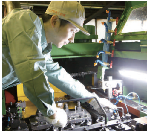
冷間ホーマーのセットアップ作業
