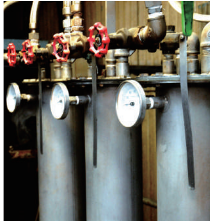
連続煮釜も自社で設計製造したオリジナル
