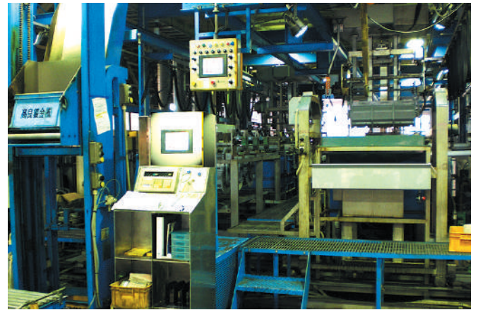
生産ラインとデータ管理を連動させた「全自動電気亜鉛めっきライン」
