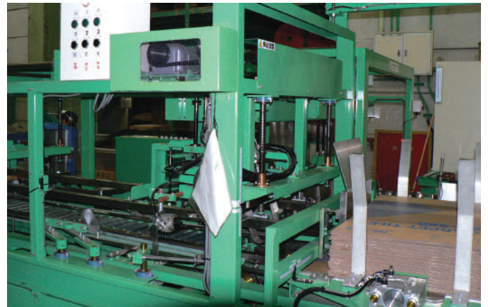
タイルカーペットのバックキング加工機
