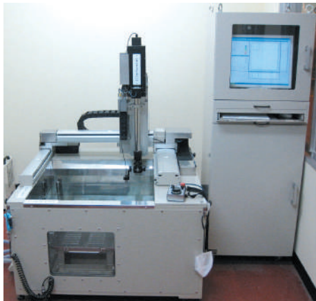
高速全波形収録を備えたオーダーメイド超音波水浸スキャンシステム
