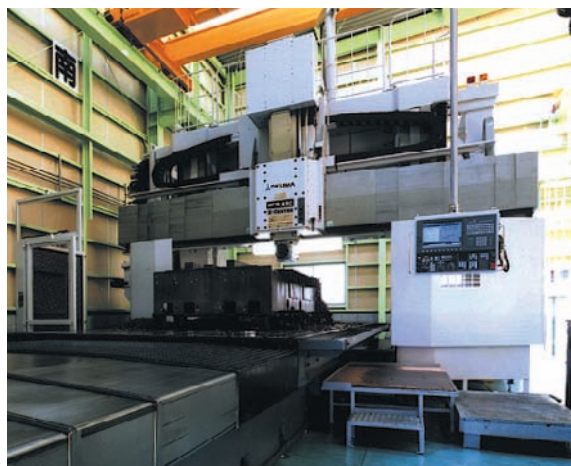
高精度・多方面のニーズに対応する 最新鋭の超大型5面加工機（門型MC）を導入
