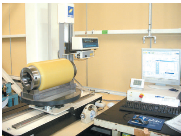
溝の角度を測定する「輪郭測定器」で細かい部分の角度や深さも測れる
